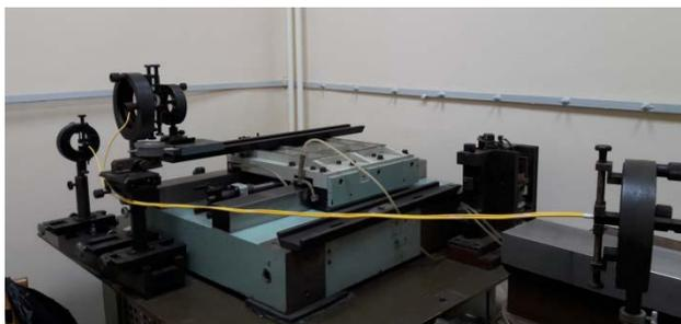
Рисунок 4. – Блок измерений (регулируемая линия задержки) лабораторного макета датчика
