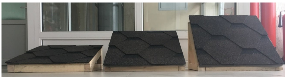
Рисунок 3. – Модельные экспериментальные образцы кровли с различным углом наклона
