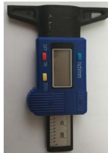
**Рисунок 3. – Глубиномер Digital Tread Depth Gauge**
