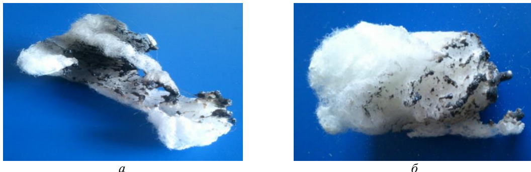
Рисунок 3. – Образцы полиэфирного нетканого утеплителя после огневого испытания: а – исходного материала; б – после ступенчатой огнезащитной обработки
