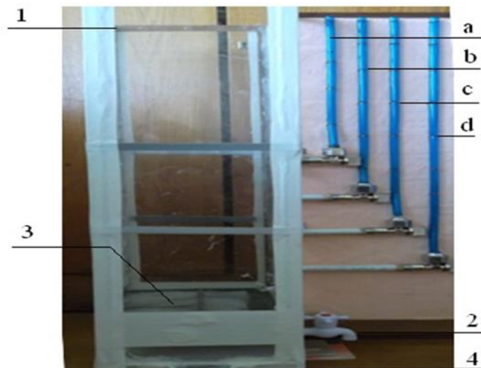
1 – вертикальная колонка прямоугольного сечения; 2 – кран для регулирования фильтрационного расхода; 3 – металлическая решетка; 4 – дно экспериментальной установки; a, b, c, d – пьезометры
