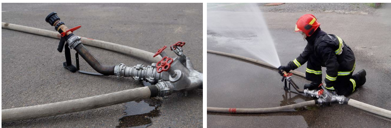
а – подключение; б – регулировка расхода и геометрии струи ствола
