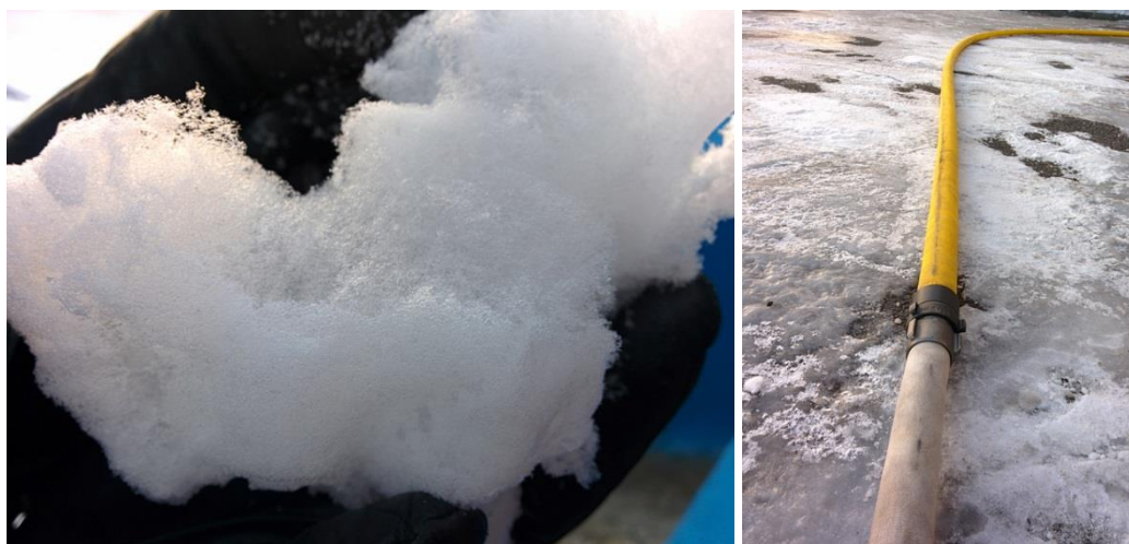
Рисунок 6 – Исследования поведения компрессионной пены при низких температурах
