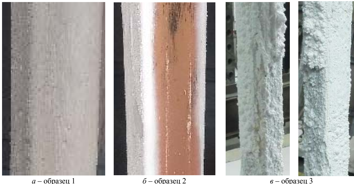
Рисунок 3. – Вид образцов после проведения огневых испытаний
