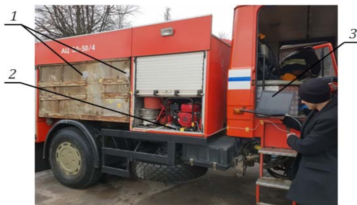
1 – тензометрические датчики; 2 – приемное устройство; 3 – портативный компьютер с установленным программным обеспечением
