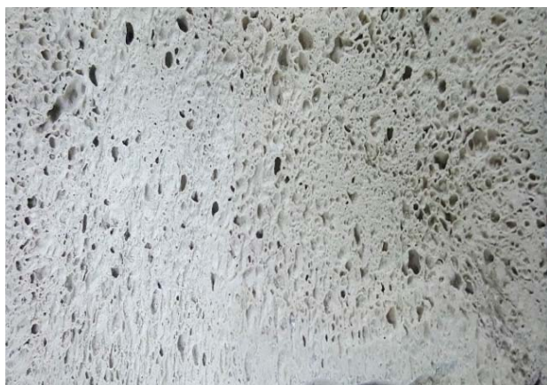
Рисунок 1. – Внешний вид нового пористого материала, образец 2 (масштаб 1:1)
