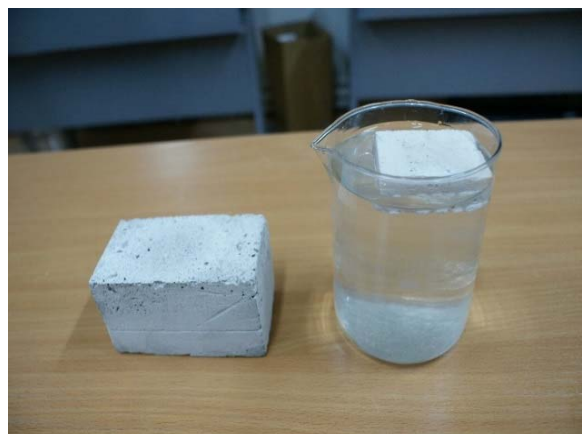
Рисунок 2. – Ультралегкий пористый материал, образец 3
