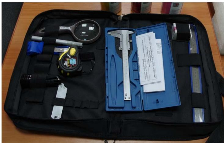
Рисунок 1. – Комплект визуального инспекторского контроля ВИК-1
