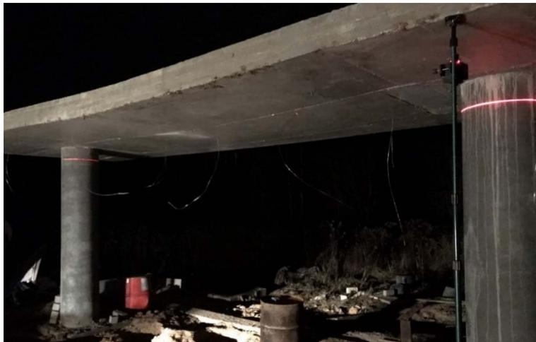
Рисунок 11. – Измерение ординаты нижних и верхних точек перекрытия после снятия опалубки
