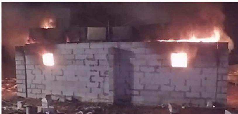
Рисунок 17. – Общий вид испытательного фрагмента перед разрушением колонн
