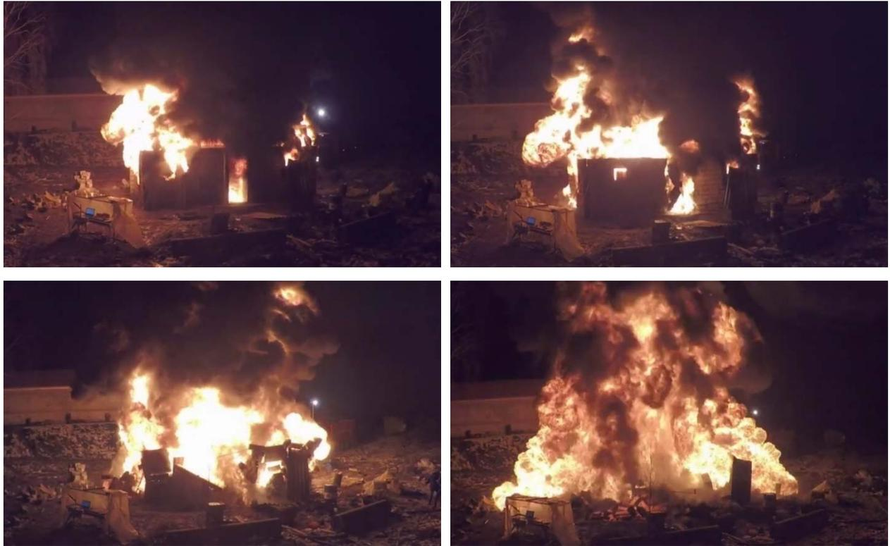
Рисунок 18. – Момент разрушения колонн и падения перекрытия
