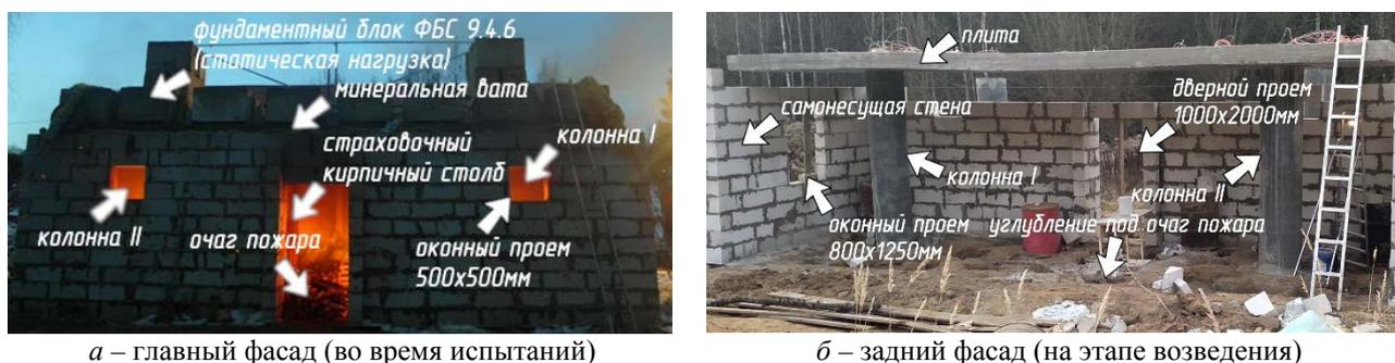
Рисунок 3. – Испытанный фрагмент здания
