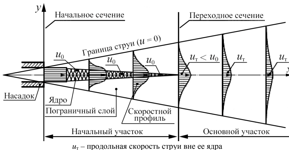
Рисунок 3. – Принципиальная схема затопленной турбулентной струи
