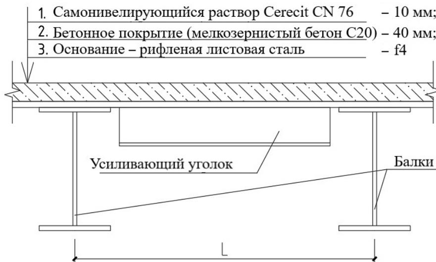
**Рисунок 1. – Детали конструкции с примыканием бетонного покрытия**
