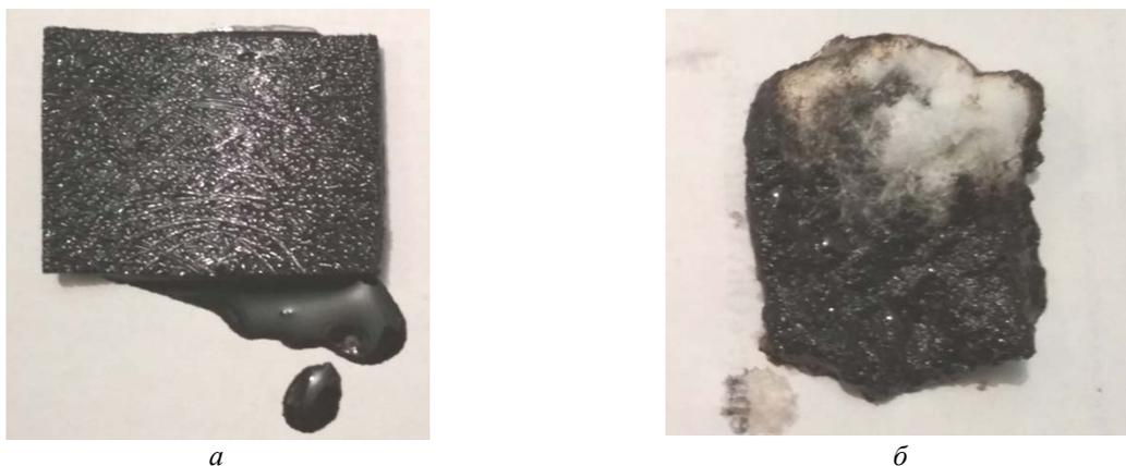
Рисунок 4. – Снимки извлеченных из нефти образцов полимерного волокнистого материала с диаметром волокон 70–100 мкм (а) и около 5 мкм (б)
