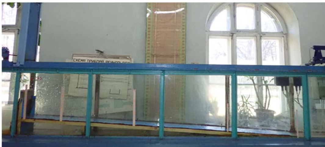
Рисунок 4. – Общий вид экспериментального лабораторного стенда с моделью нижнего бьефа (сухого русла)
