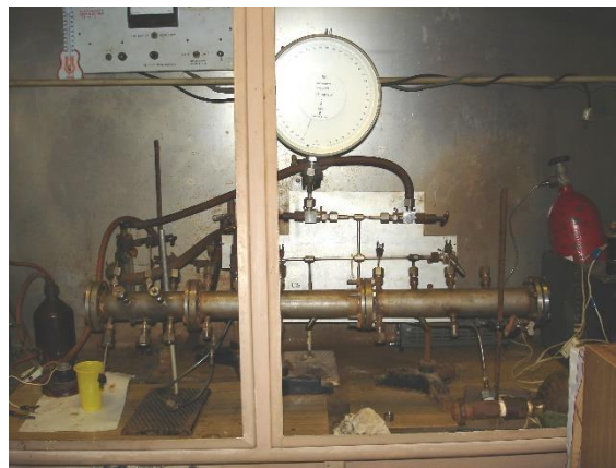
Рисунок 1. – Экспериментальные установки по исследованию пожарной опасности альтернативных хладонов и фотовоспламенения хлорсодержащих горючих смесей
