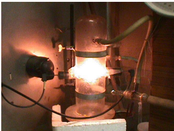
Рисунок 1. – Экспериментальные установки по исследованию пожарной опасности альтернативных хладонов и фотовоспламенения хлорсодержащих горючих смесей
