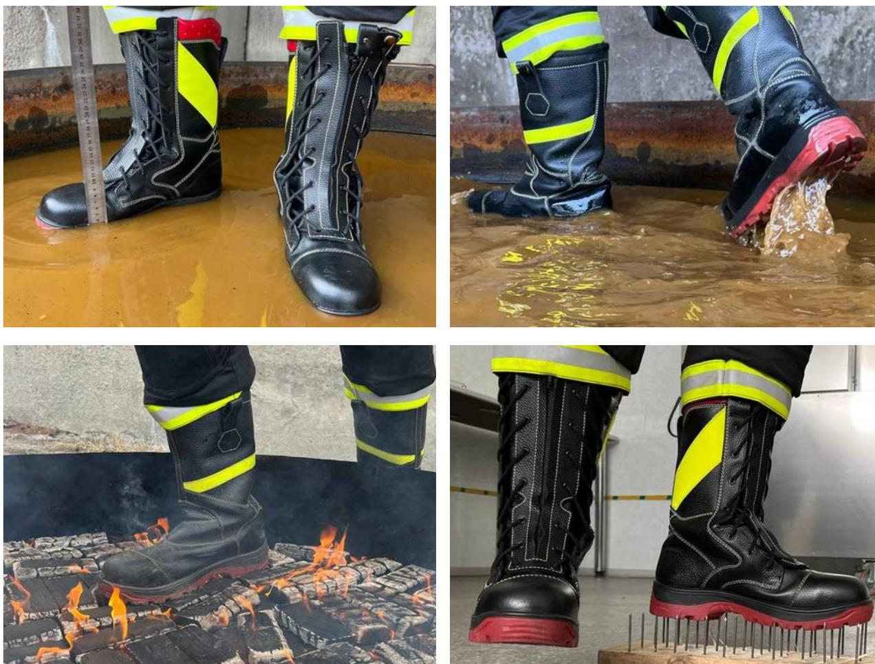
Рисунок 4. – Эксплуатационные испытания обуви
