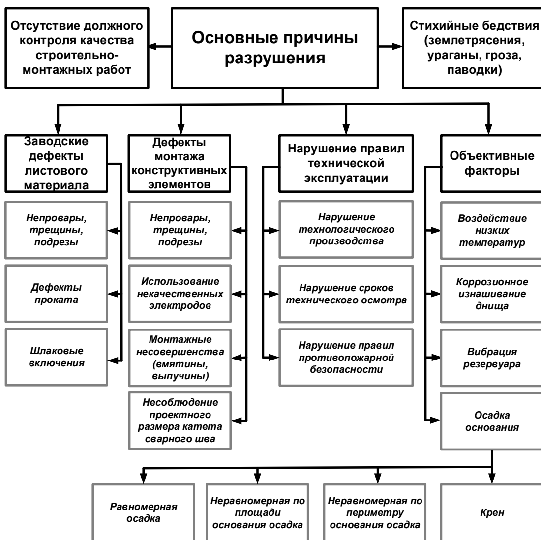
Рисунок 1. – Основные причины разрушения РВС
