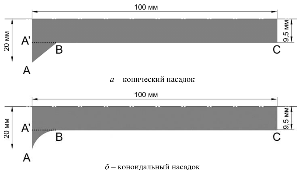
Рисунок 4. – Геометрическая модель проточного тракта насадка
