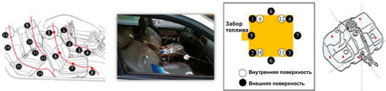
Рисунок 4. – Расположение и количество термопар: в салоне автомобиля, в моторном отсеке, на бамперах и топливном баке
