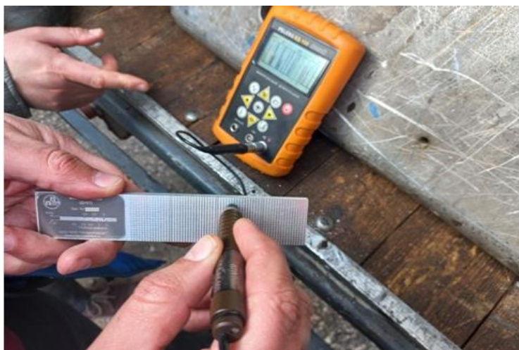
Рисунок 5. – Настройка чувствительности дефектоскопа ВД-100 по искусственному дефекту глубиной 0,6 мм с шероховатостью поверхности R_z = 40 мкм
