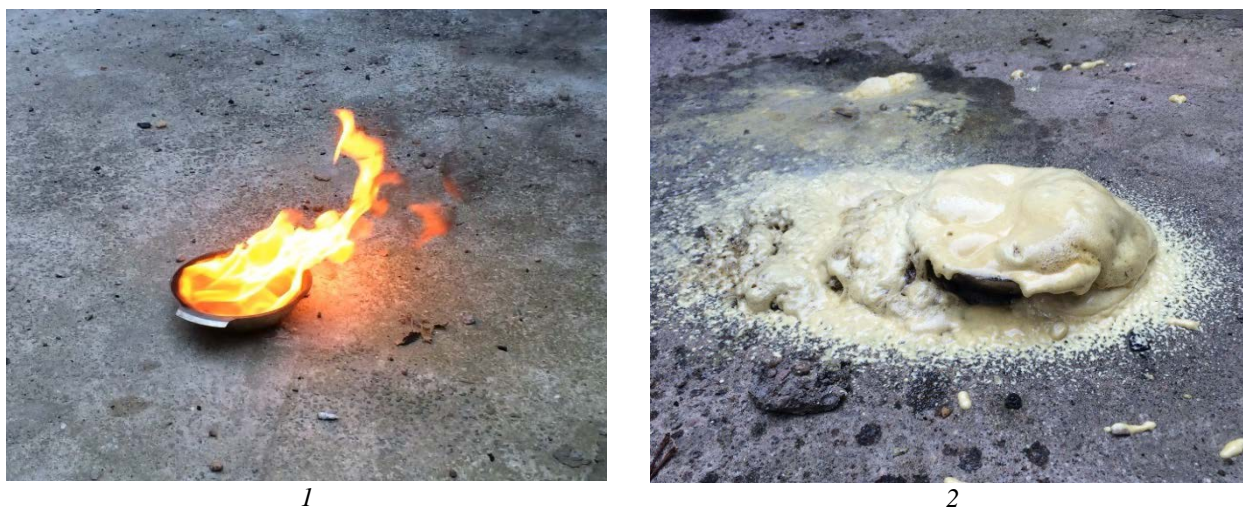
Рисунок 1. – Тушение антипирированным пенополиуретаном лабораторного очага пожара класса В
