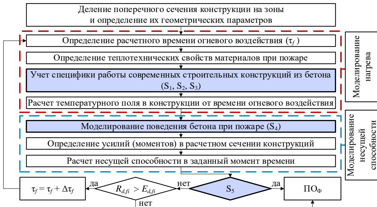
Рисунок 3. – Алгоритм моделирования работы конструкций из бетона при пожаре
