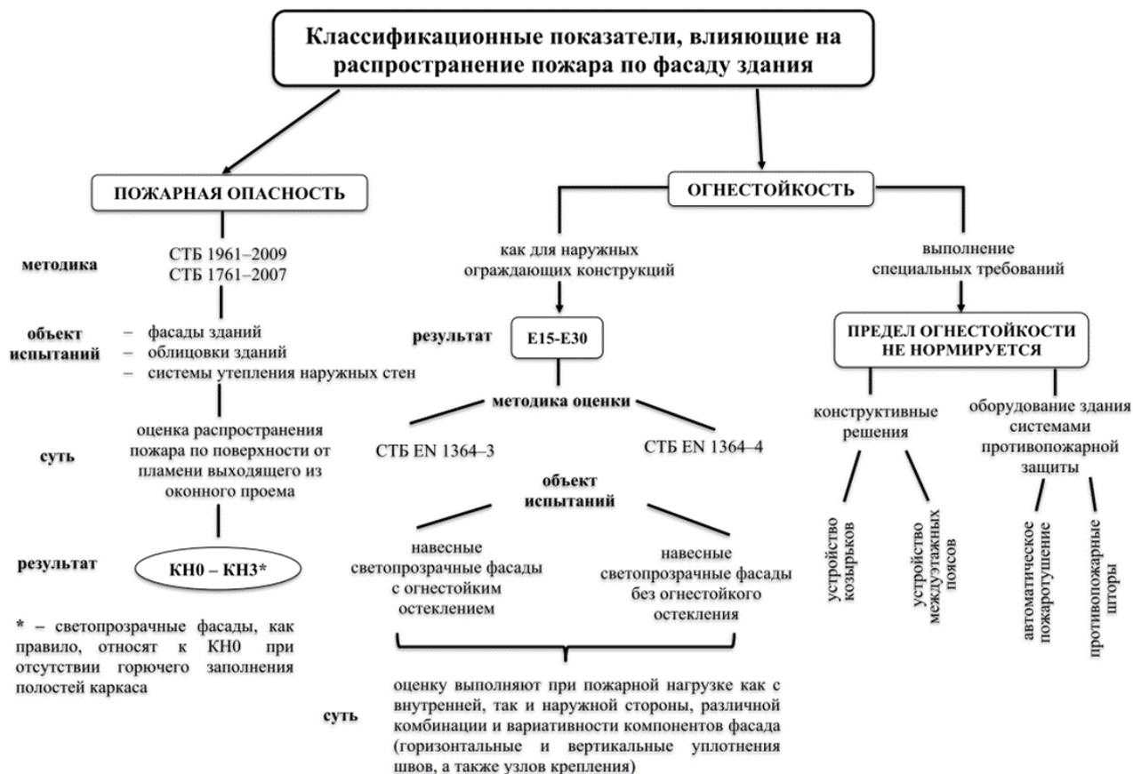
Рисунок 2. – Классификационные показатели, влияющие на распространение пожара по фасаду здания
