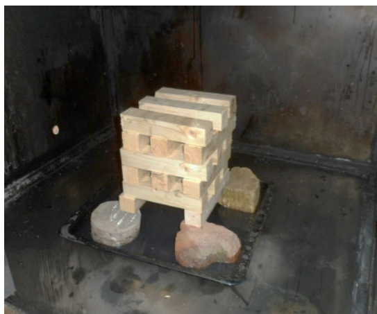
а – модельный очаг в виде деревянного штабеля
