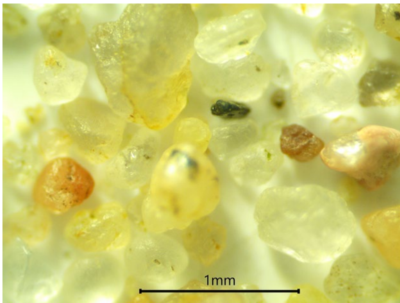
Рисунок 11. – Речной песок (зернистость F22–F150)
