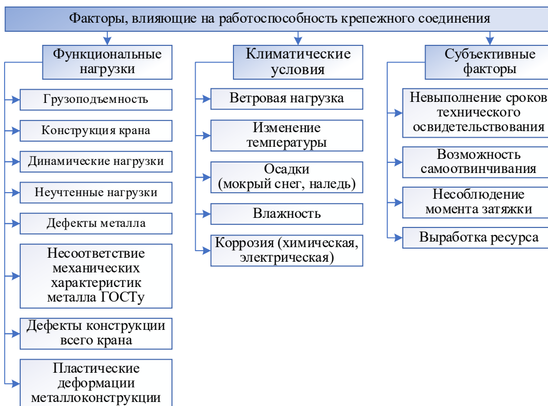
Рисунок 7. – Факторы, влияющие на работоспособность болтовых соединений ОПУ
