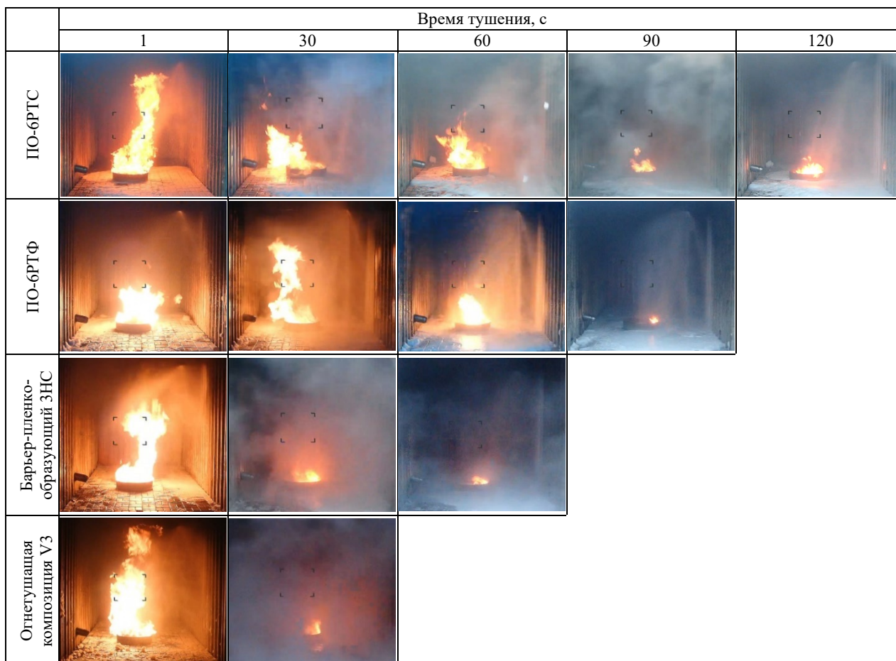
Рисунок 5. – Раскладка тушения модельного очага пожара различными огнетушащими составами
