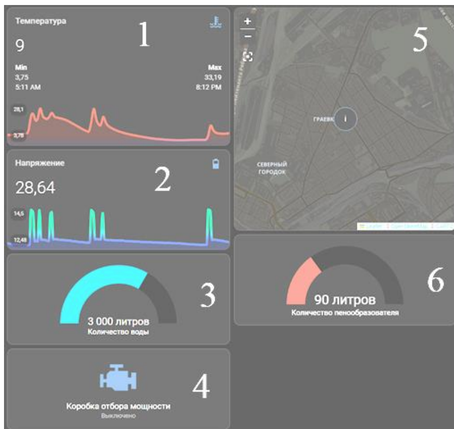
1 – текущая температура в салоне автоцистерны и ее график за 24 ч; 2 – текущее напряжение в бортовой сети автоцистерны и его график за 24 ч; 3 – текущий уровень воды в цистерне; 4 – состояние коробки отбора мощности (выключена); 5 – карта с текущим расположением автоцистерны; 6 – количество пенообразователя в пенобаке
