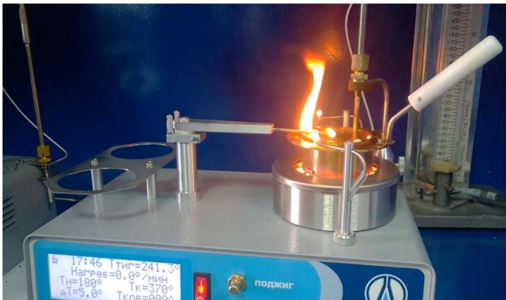
Рисунок 4. – Фиксация температуры вспышки на установке ТВО-ЛАБ-01 по ГОСТ 4333 экструдированного пенополистирола производителя «А»
