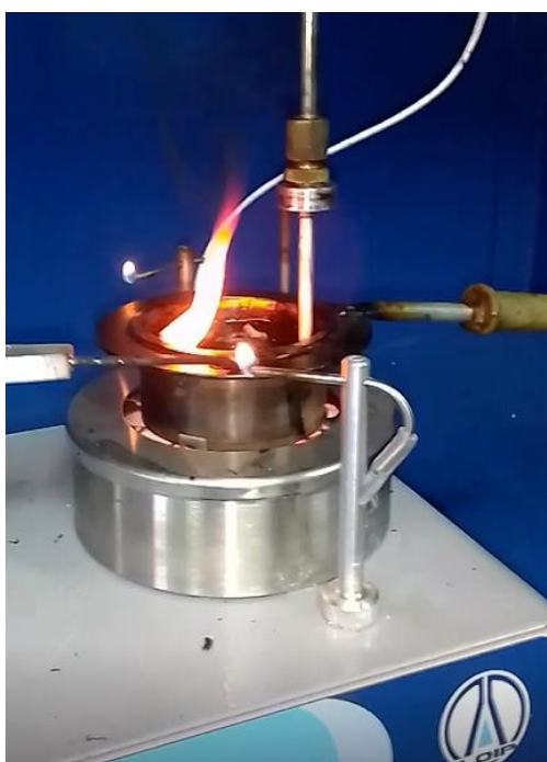
Рисунок 5. – Фиксация температуры вспышки на установке ТВО-ЛАБ-01 по ГОСТ 4333 экструдированного пенополистирола производителя «Б»
