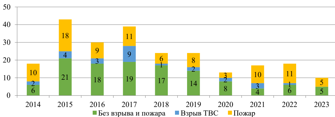
Рисунок 1. – Распределение аварий на объектах трубопроводного транспорта органического топлива по годам
