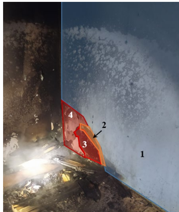
б – распределение зон с различными термическими повреждениями ГКЛВ
