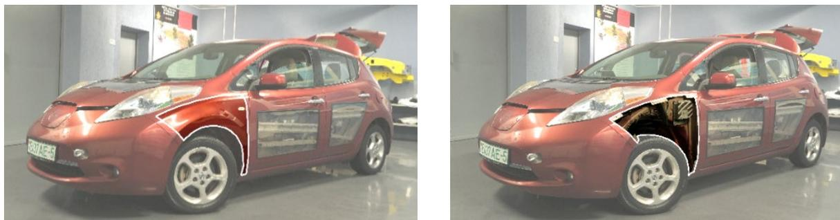
Рисунок 2. – Переднее левое крыло МГМ электромобиля
