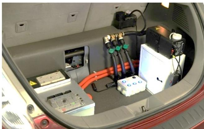
Рисунок 7. – Багажный отсек МГМ электромобиля
