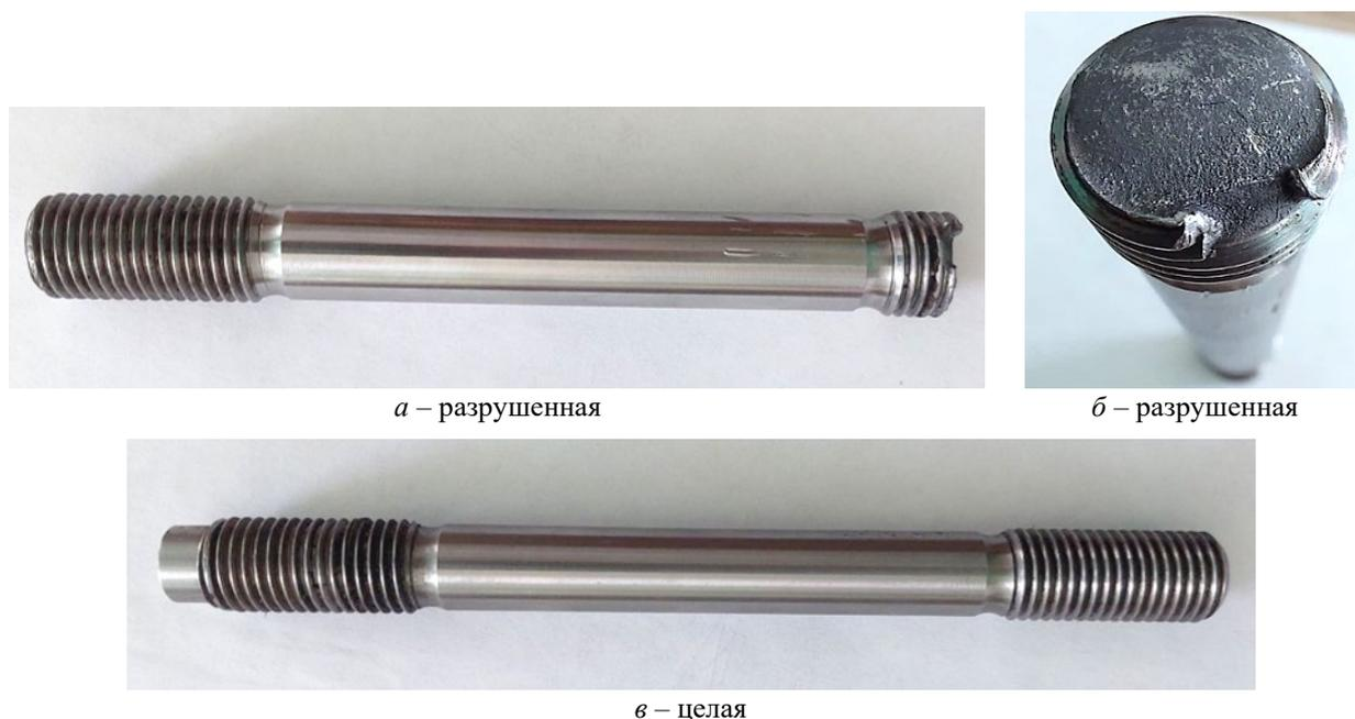
Рисунок 3. – Общий вид (а, в) и морфология излома (б) шпилек, предоставленных на исследование, х4
