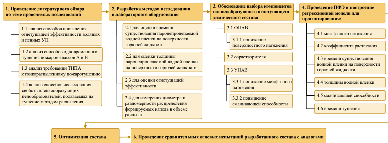
Рисунок 1. – Порядок разработки пленкообразующего огнетушащего химического состава для автоматических установок пожаротушения водой и пеной, подаваемого методом распыления
