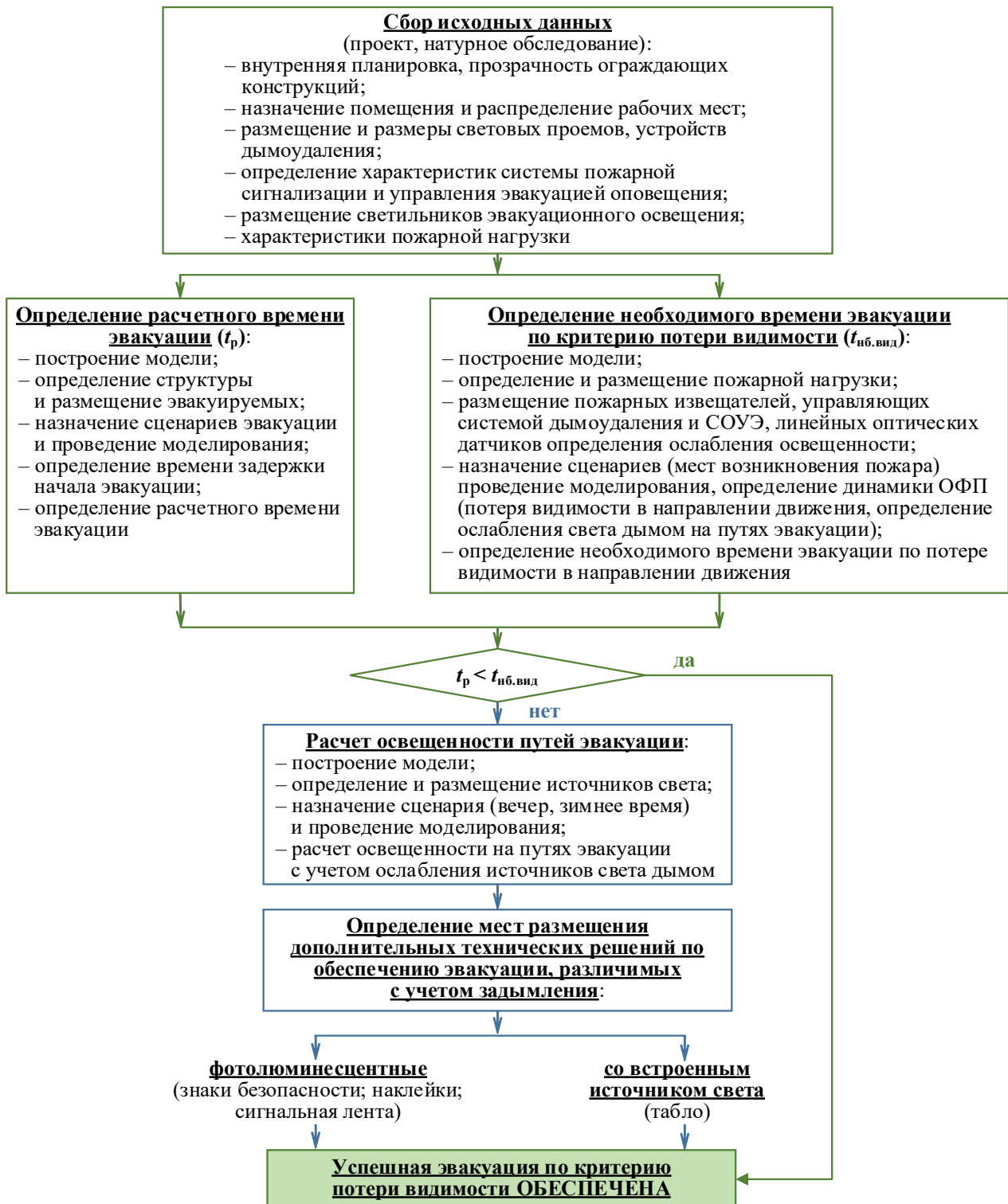
Рисунок 12. – Алгоритм определения дополнительных мероприятий обеспечения успешной эвакуации людей из зданий по критерию потери видимости
