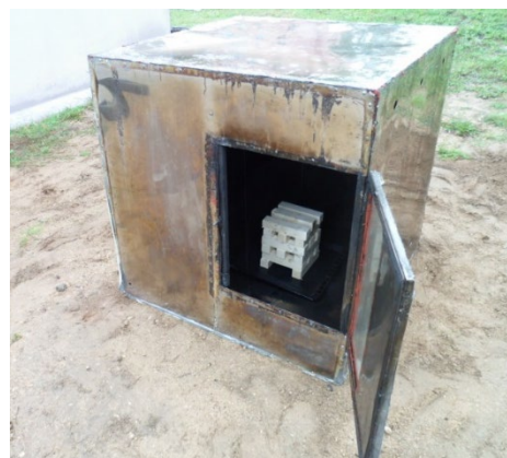
Рисунок 3. – Испытательная огневая камера
