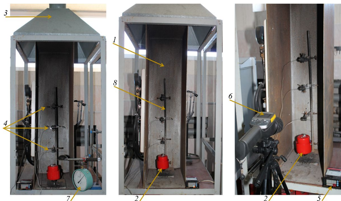
1 – корпус камеры; 2 – экспериментальный образец ГОВА; 3 – вентиляция; 4 – термопары; 5 – контрольно-измерительный прибор; 6 – тепловизор; 7 – трубка Пито; 8 – штатив Рисунок 2. – Испытательный стенд для исследования образцов ГОВА
