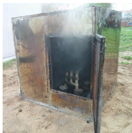
Рисунок 5. – Итог полигонных испытаний экспериментального образца ГОА по тушению модельного очага
