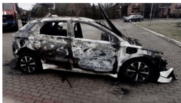
Рисунок 7. – Возгорание неизвестного BEV (17 января 2025 г., д. Междуречье)
