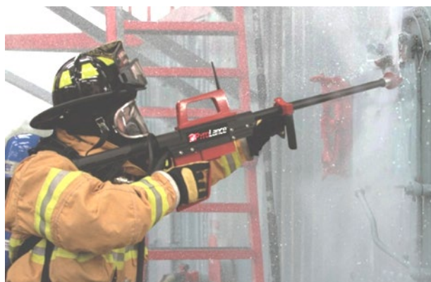
б – подача огнетушащих веществ через стену установкой PyroLance
