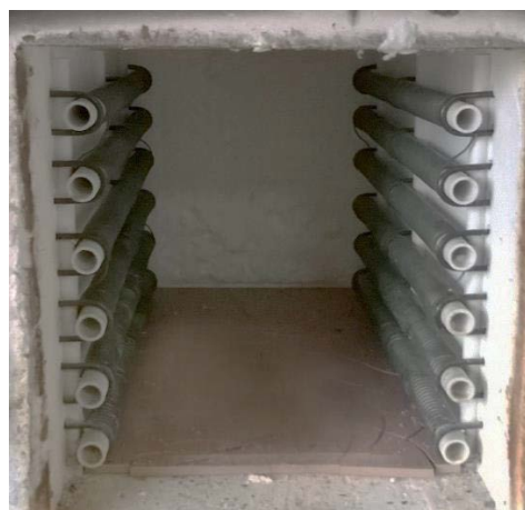
б) общий вид рабочей камеры с открытыми нагревательными элементами
