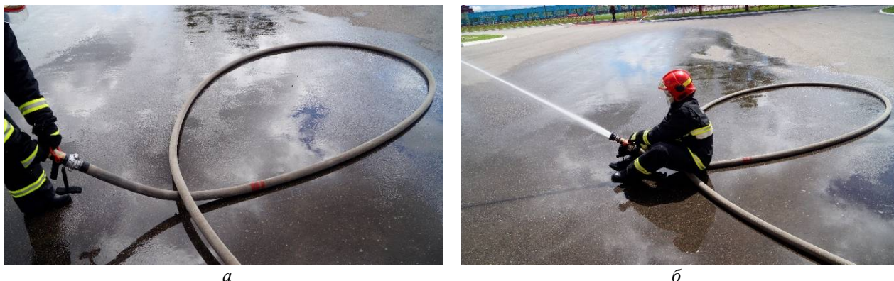
а – фиксация ствола рукавной линией; б – работа ствольщика с зафиксированным стволом Рисунок 4. – Фиксация ствола при помощи рукавной линии и веса ствольщика
