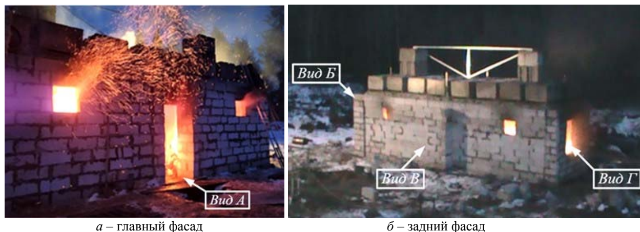
Рисунок 5. – Общий вид фрагмента при проведении натурных огневых испытаний
