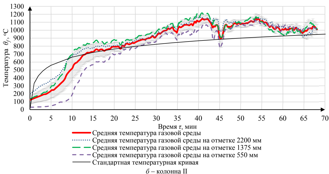
Рисунок 6. – Температура газовой среды, воздействующей на колонны
