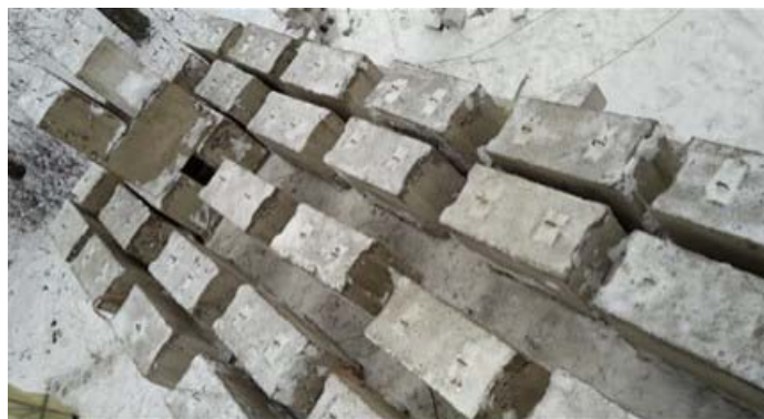
Рисунок 3. – Размещение статической нагрузки на плите фрагмента
