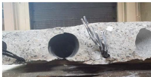
б) разрушение защитного слоя экспериментальных образцов
