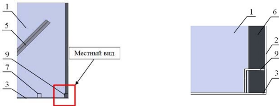
д – вид сбоку модернизированной цистерны с установкой уголков
