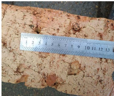
z – входное отверстие при испытании кирпича полнотелого одинарного КРО М-175
