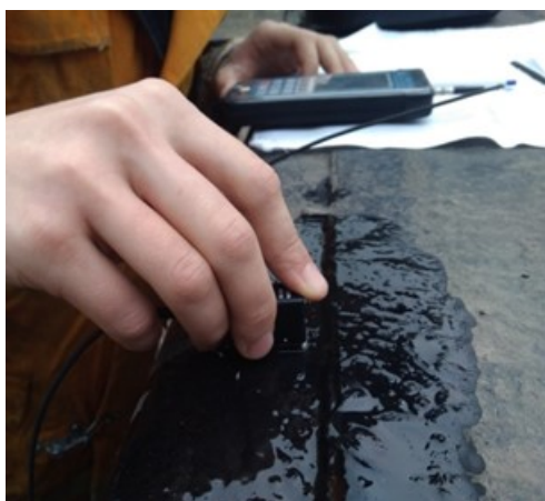
в – проведение ультразвуковой дефектоскопии
