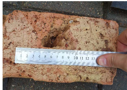
d – выходное отверстие при испытании кирпича полнотелого одинарного КРО М-175
