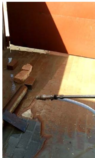
б – вид насадка, закрепленного на стволе высокого давления
