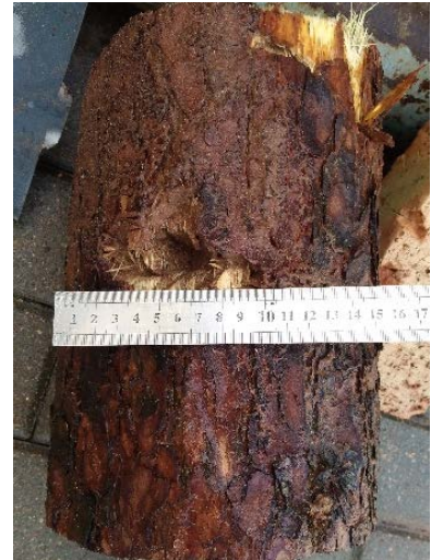
в – свежеспиленный сосновый брус диаметром 150 мм
