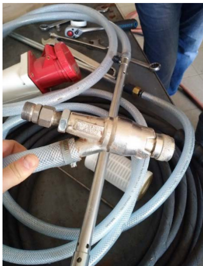
а – общий вид пескоструйного насадка, применяемого при проведении эксперимента
