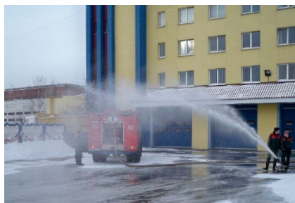
б – работа распылителя без подачи воздуха
