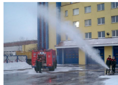
в – работа распылителя с подачей воздуха, p_a = 0,9 МПа
