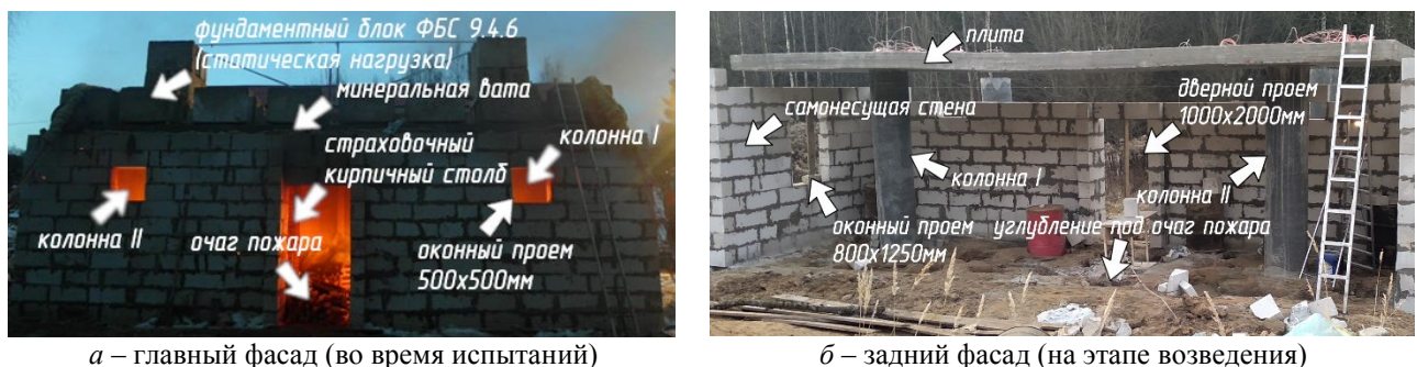
Рисунок 3. – Испытанный фрагмент здания
