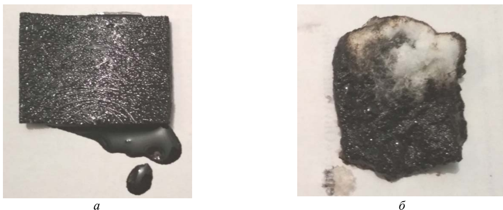
Рисунок 4. – Снимки извлеченных из нефти образцов полимерного волокнистого материала с диаметром волокон 70–100 мкм (а) и около 5 мкм (б)
