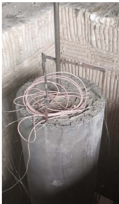
а – образец без конструктивной огнезащиты
