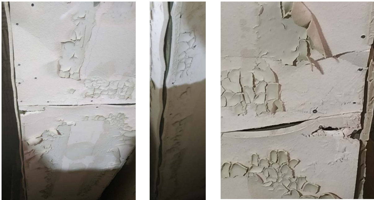
б – образец с конструктивной огнезащитой 12,5 мм
