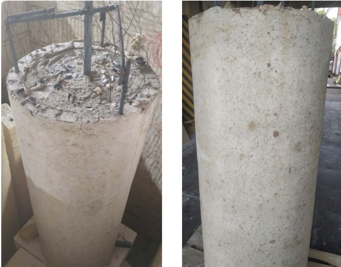
а – образец без огнезащиты
