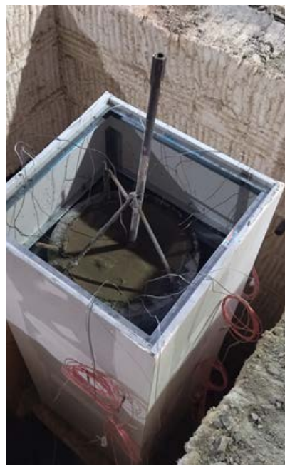
б – образец с конструктивной огнезащитой толщиной 20 мм
