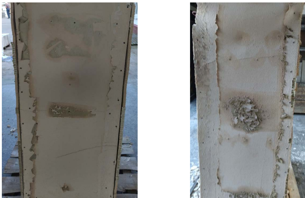
6 – образец с конструктивной огнезащитой 20 мм
