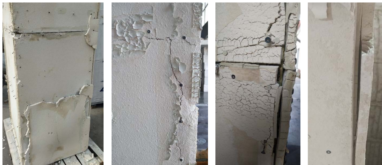
2 – образец с конструктивной огнезащитой 40 мм
