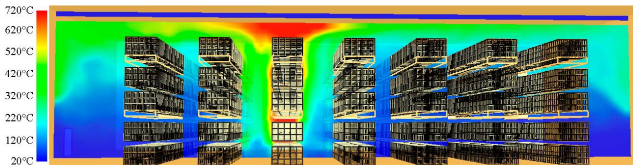
Рисунок 2. – Поле распределения температуры в помещении склада в момент достижения ее максимального значения 720 °С в перпендикулярной потолку плоскости, проходящей через очаг пожара
