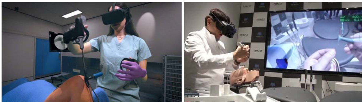
Рисунок 11. – Виртуальные симуляторы с тактильной обратной связью для хирургов и стоматологов от компании Osso VR 8
