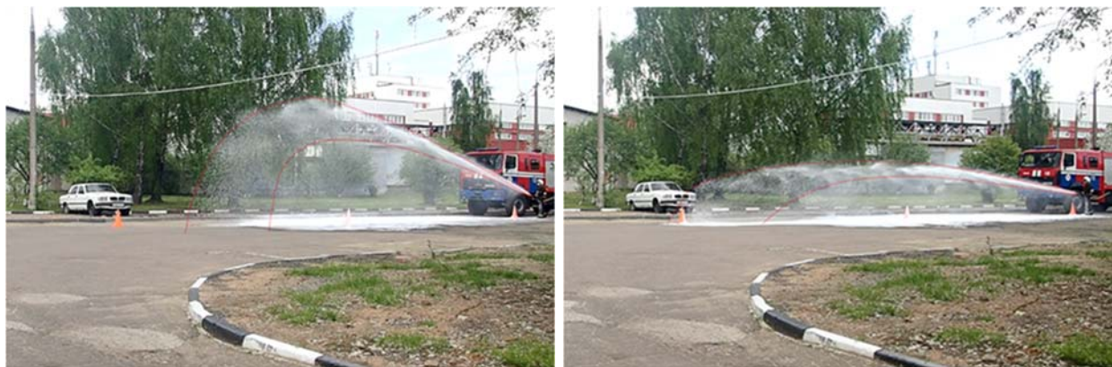
Рисунок 3. – Подача ствола РСК-50 при угле наклона к горизонту 30° и 10° соответственно
