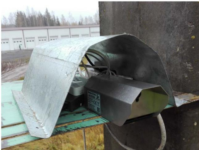
Рисунок 4. – Внешний вид лазерного датчика
